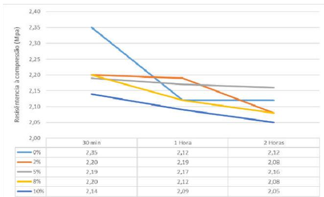
Figura 10. Resistência/Tempo faixa de temperatura de 1029°C
