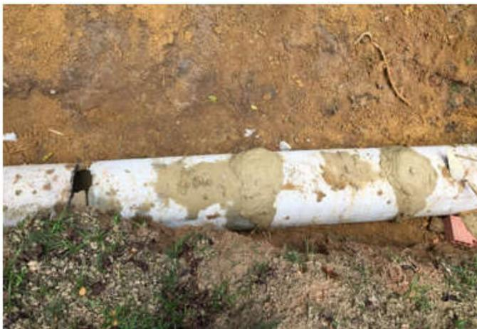
Fig. 3: Tubo quebrado, aguardando o retrabalho. Fonte: Os Autores, 2020
