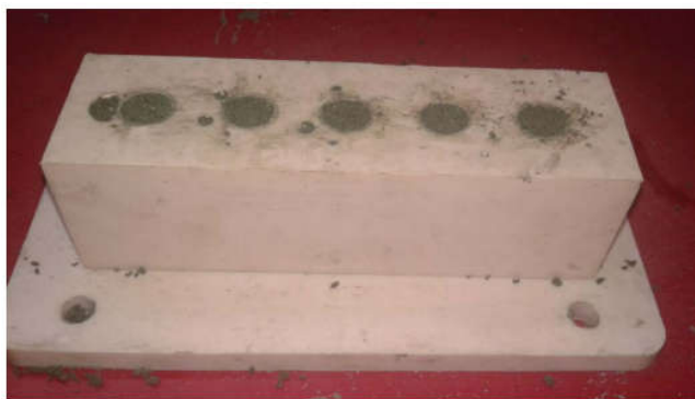
Figura 7. Detalhe de corpos-de-prova cilíndricos após sua moldagem em molde de silicone
